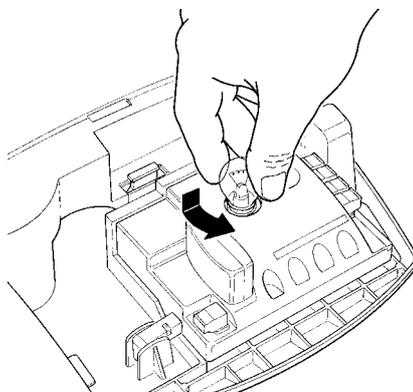
3. Dla SN6030, SN6031, SN6040 i SN6041: Wykręcić zepsutą żarówkę. Włożyć nową żarówkę o parametrach: 230V / 60W wtyk E27.
