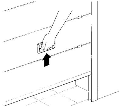
**Accionamiento con dispositivos de seguridad fuera de uso:** si los dispositivos de seguridad montados en la puerta no funcionaran correctamente, es de igual forma posible accionar la puerta.
