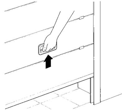
**Torbewegung mit Sicherheitsvorrichtungen außer Betrieb:** sollten die am Tor vorhandenen Sicherheitsvorrichtungen nicht korrekt funktionieren, kann das Tor trotzdem bewegt werden.
