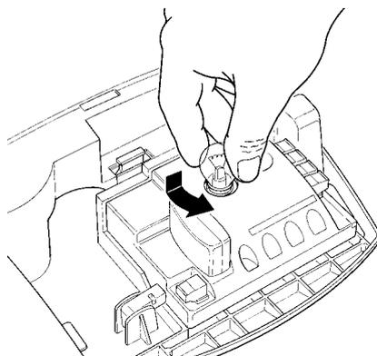
3. Pour SN6031 et SN6041: dévisser l'ampoule défectueuse. Mettre une ampoule neuve de 230 V / 60 W douille E27.
