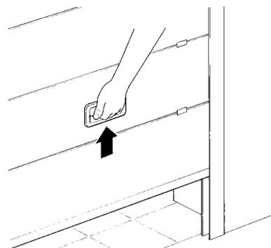
**Commande avec sécurités hors service:** Si les dispositifs de sécurité ne fonctionnent pas correctement ou sont hors service, on peut quand même commander la porte.
