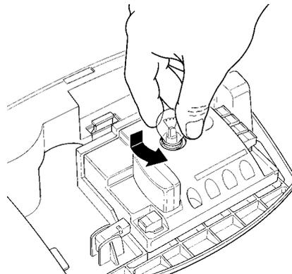
3. Para SN6031 y SN6041: desenrosque la bombilla que no funciona. Coloque una bombilla nueva de 230V / 60W conexión E27.
