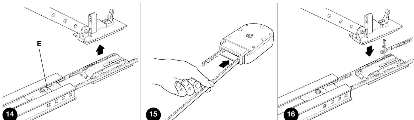
5. Breng de riemaanspanner en de wagen weer terug op de plaats van daarvoor. Assembleer de kop van de geleiderail (A), zoals op afbeelding 17 te zien is. Hiervoor hebt u een bepaalde kracht nodig, gebruik eventueel een rubber hamer.
