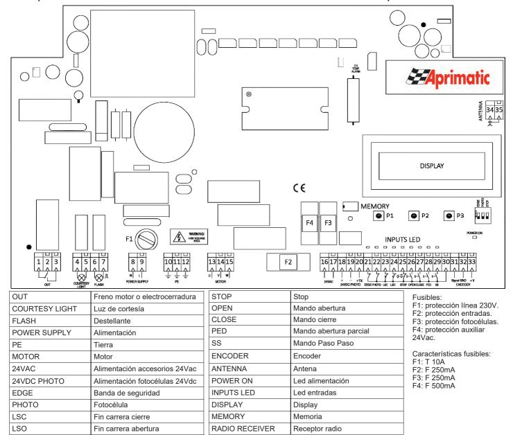
Para la conexión del motor se aconseja usar cable blindado 3 polos + tierra de 1.5mm² (tipo FD781CY). Para la conexión del eventual encoder se aconseja utilizar cable blindado 3 x 0,75mm² (tipo OLFLEX-110CH).
